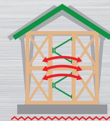
制震工法とは、地震エネルギーを吸収する制震装置によって建物の変形を抑える工法です。変形を抑えて建物本来の耐震性能を維持するため繰り返しの地震に対して高い効果を発揮します。
