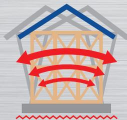
耐震工法とは、筋交いや面材によって強度を高めて地震の揺れに耐える工法です。固定箇所は地震を受けるたびにどんどん緩んでいくため、全体のバランスが取れていなければ弱いところに緩みが集中し全体損傷につながります。
