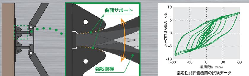
曲面サポートが強靱鋼棒の変形をコントロール
