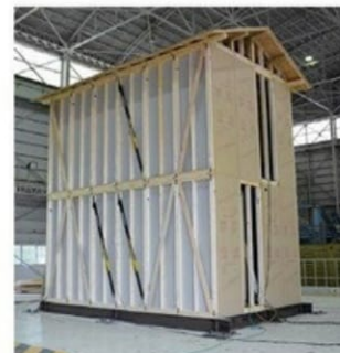
実大2階建住宅の振動台実験 (防災科学技術研究所)
