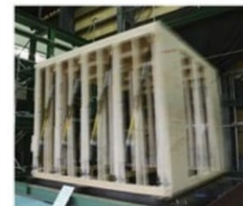
48回加振した実大住宅の振動台実験 (京都市大学防災研究所)
